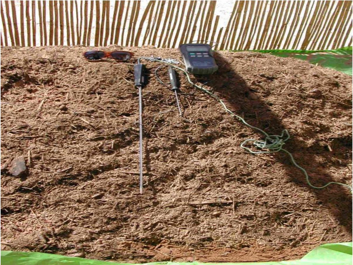
Photo 3 : Thermomètres à sondes métalliques.
