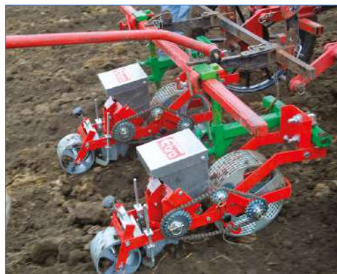
Semoir deux rangs très solide (mais trop coûteux) permettant un écartement constant entre lignes
