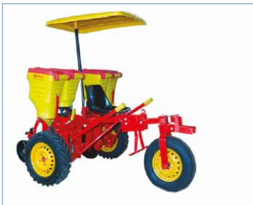
Semoir 2 rangs de traction animale, Brésil (www.fitarelli.com.br/)
