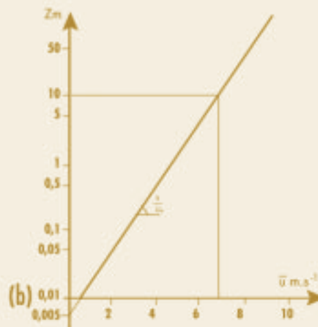
Profil de vitesse du vent au voisinage du sol représenté en coordonnées cartésiennes (a) et semi-logarithmiques (b)
